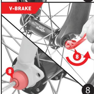
**CZ** Přední osu kola vsuňte do náboje a kolo vložte do přední vidlice. Dávejte pozor, aby kolo bylo symetricky umístěno mezi rameny vidlice. Dotáhněte rychloupínák nebo šroub **8**.
