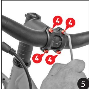
**CZ** Řídítka vložte do představce a postupným utahováním šroubů **4** je zafixujte. POZN.: Šrouby dotahujte postupně do kříže proti sobě (všechny stejným dotahovacím momentem 8 - 9 Nm).
